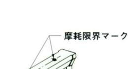
打撃板……摩耗部の穴が消滅
